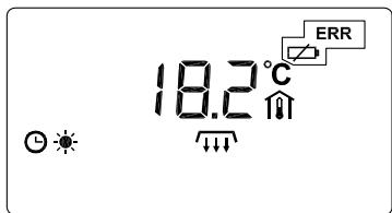
Batteriefehler: Batterie entladen oder schwach. Die Batterie muss sofort gewechselt werden. Die Batterie ist im Inneren des Gerätes zu finden. Typ: 1,5V (AA). Langanhaltende Batterien verwenden. Während des Batteriewechsels bleiben die Daten der Uhr auch ohne Batterie 2 Minuten lang aufbewahrt.
